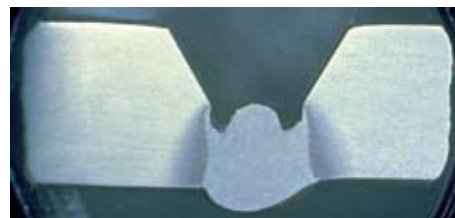
用手工焊进行的带间隙的根部打底焊。
