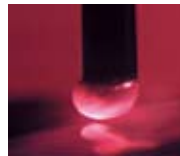
采用CO 2 保护气体和0.045实芯焊丝焊接时的传统的恒压短路过渡
