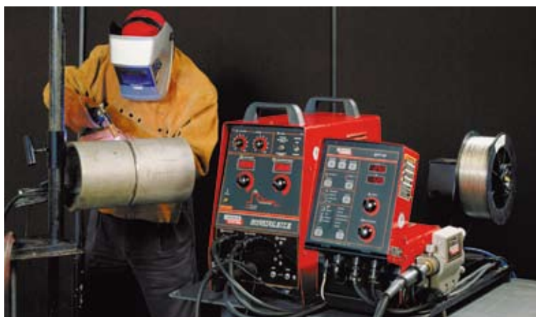
采用STT焊接工艺，100%CO 2 和0.045英寸（1.2mm）焊丝进行焊接。
