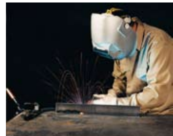
采用CO 2 保护气体和0.045实芯焊丝焊接时的STT（表面张力过渡），注意它减少了飞溅和烟雾
