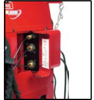
不带任何适配器的水冷焊枪接线——机侧安装避免触碰并起到保护作用。
