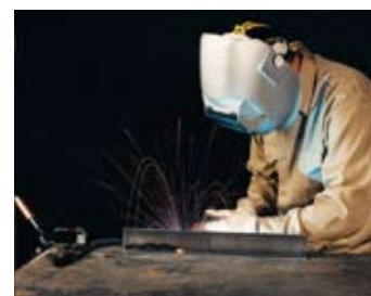
应用CO 2 气体保护和0.045的实芯焊丝焊接时的STT（表面张力过渡），注意它减少了飞溅和烟雾
