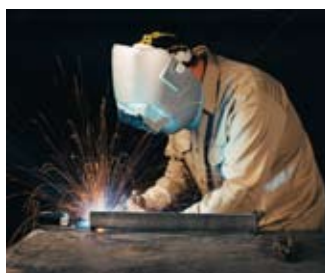
应用CO 2 气体保护和0.045的实芯焊丝焊接时的传统的恒压短路过渡
