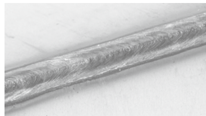
低电压焊接不锈钢时，Power mode减少飞溅，改善焊缝外观
