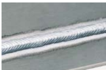
Pulse-on-pulse应用在3mm铝焊接中
