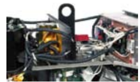
配套的保护套能保护焊丝导向免遭破坏。
