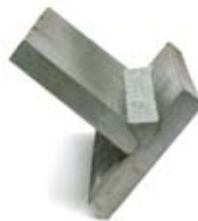
高熔敷率角焊缝
